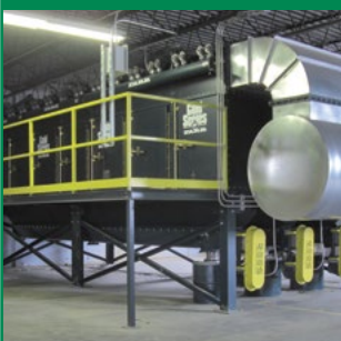
Specielfremstillet flex-tip cellesluse til fiberholdigt støv
