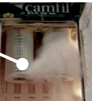
Jetpulsrensning af Gold Cone-filter.
