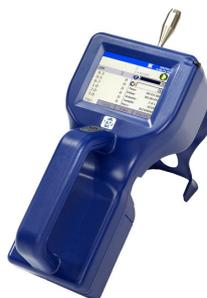
Contador láser TSI Aerotrak mod.9306
