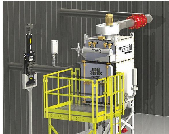
Ejemplo de una unidad de captación de polvo con varios elementos de seguridad, especificada en función de las características particulares del polvo y gas existentes en una determinada aplicación
