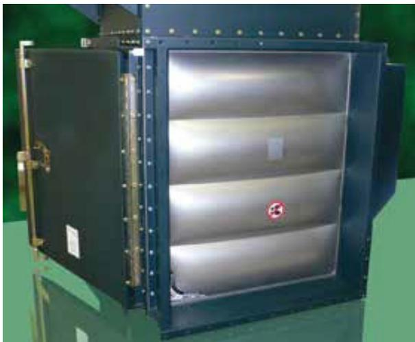
Diseñados para ser el punto "débil" del recipiente, los venteos anti-explósión se abren cuando se alcanzan presiones preestablecidas dentro del captador de polvo, permitiendo que la sobrepresión y el frente de llama escapen a una zona segura. Los venteos anti-explósión minimizan los daños al captador de polvo causados por la sobrepresión creada por una deflagración.
