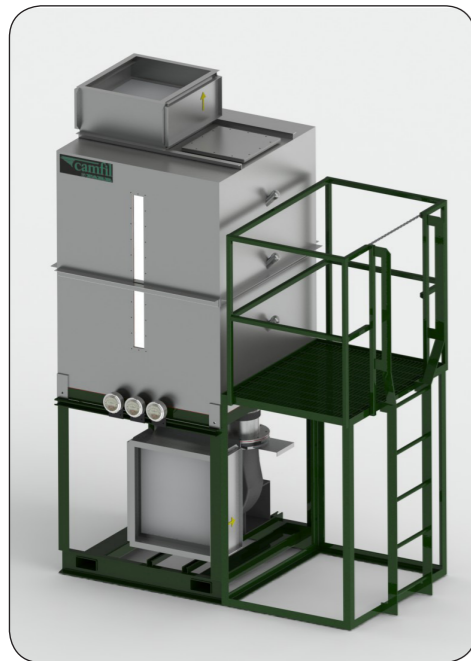
Kuvia eri HDB-kokoonpanoista, joissa näkyvät: puhallin, huoltotaso ja -tikkaat, paine-eromittarit, esi- ja jälkisuodattimet, kulloinkin tarpeellinen määrä suodatusmassojen näytteenottoportteja ja tarkastusikkuna, jota käytetään CamPure 4, 8, 9 ja 10 suodatusmassojen kanssa.
