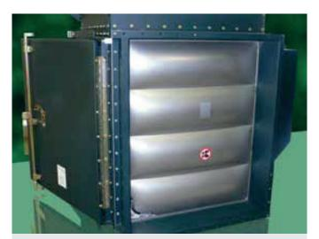
Als "Schwachstelle" des Behälters konzipiert, öffnen sich die Berstscheibe, wenn ein vorher festgelegter Druck im Inneren erreicht wird, sodass der Überdruck und die Flammenfront in einen sicheren Bereich entweichen können. Vorrichtungen zur Explosionsentlastung minimieren Schäden am Entstaubungssystem, die durch den bei der Verpuffung entstehenden Überdruck entstehen.
