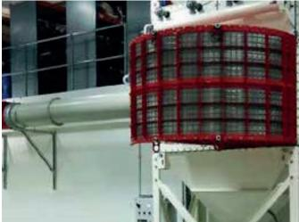
Die flammenlose Druckentlastung ist für die Installation über einer herkömmlichen Entlüftung vorgesehen und löscht die aus dem entlüfteten Bereich austretende Flammenfront, sodass sie nicht aus dem System entweichen kann. Dadurch kann eine konventionelle Entlüftung in Innenräumen durchgeführt werden, wo sie sonst das Personal gefährden könnte. Sie können nicht in einen anderen sicheren Bereich entlüften (Gefahr der Sekundärentzündung).
