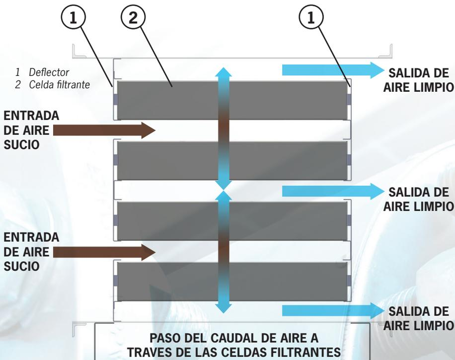
**Imagen ilustrativa de flujo de aire a través de una unidad de paso único**
