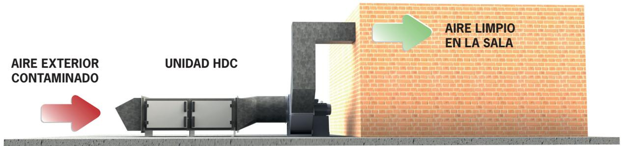
**INSTALACIÓN TÍPICA DE EXTRACCIÓN DE AIRE**
