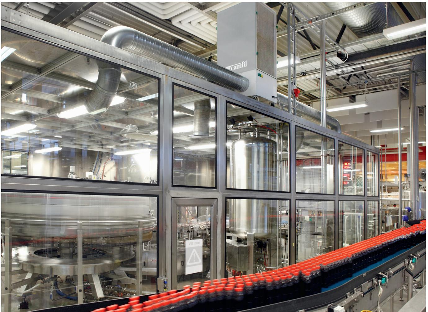
Mit Hilfe des Luftreinigers wird im Zonenbereich der Abfüllung saubere Umgebungsluft produziert.
