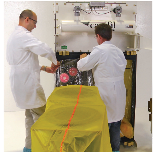
"Bag-In/Bag-Out" (BIBO) Filterwechsel im Rahmen eines Tests mit Ersatzstoffen. Mit diesen Tests kann die Leistung von Absaugsystemen in Containment-Anwendungen bestimmt werden.
