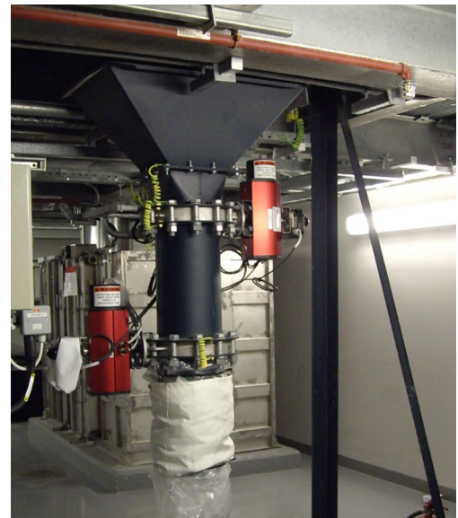
Der Endlossack wird am Austragssystem eingesetzt, um den während der automatischen Impulsreinigung des Abscheiders aus den Patronen freigesetzten Staub aufzufangen.
