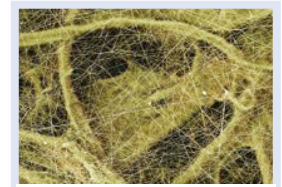
Filtermedium mit Nanofaser-Beschichtung
