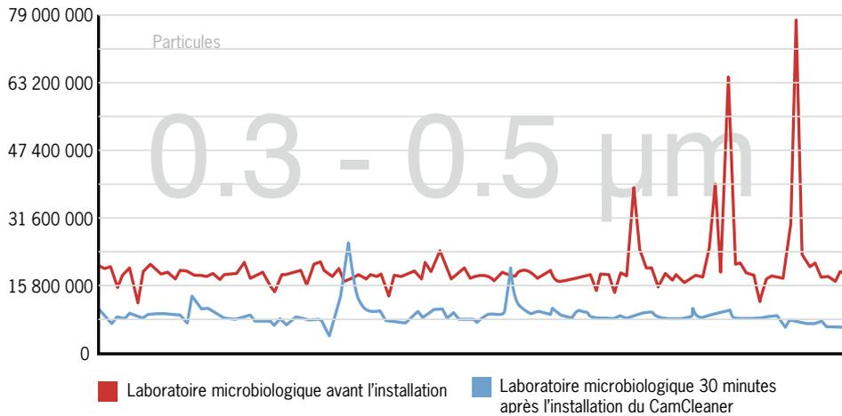
Ce graphique montre que le CamCleaner permet de réduire de façon significative les particules dans le laboratoire. Les pics représentent une activité produisant des particules en suspension qui sont éliminées lorsque le purificateur fonctionne.
