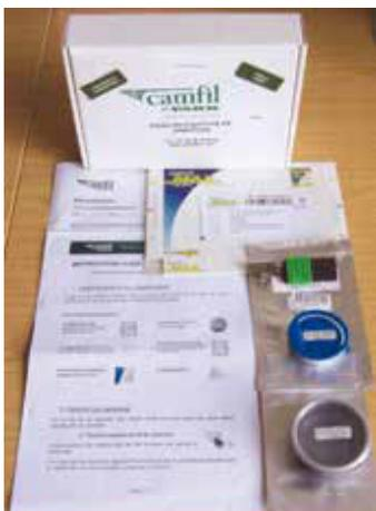
Les capteurs du kit QAI Citycheck peuvent être utilisés pour prélever un échantillon de contaminants provenant de l'air intérieur pouvant présenter un risque pour la santé. Les principaux tests sont réalisés pour les composés organiques volatils (COV) et les aldéhydes.
