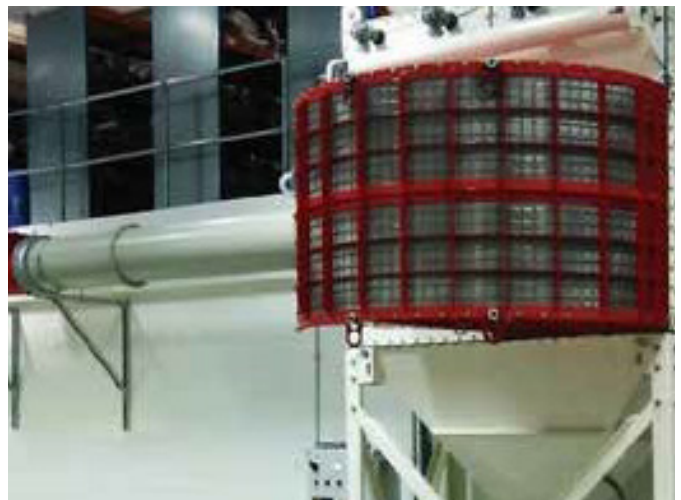
Die flammenlose Druckentlastung ist für den Einbau über einer konventionellen Entlüftung vorgesehen und löscht die aus dem entlüfteten Bereich austretende Flammenfront, so dass diese nicht aus dem System entweichen kann. Auf diese Weise kann eine konventionelle Entlüftung in Innenräumen installiert werden, wo sie sonst das Personal gefährden könnte. Eine Entlüftung in einen anderen sicheren Bereich ist nicht möglich (Gefahr der Sekundärentzündung).
